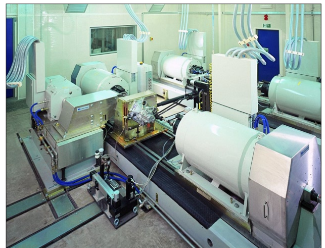
Abbildung 1: Antriebsstrang-Prüfstand zur Erprobung von Getrieben und Achsgetrieben.
