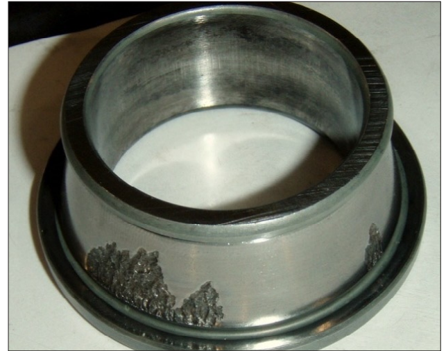
Abbildung 8: Schaden am Innenring der Ritzelkopflagerung eines Achsgetriebes. Pittinggröße ca. 25 mm 2 und 5mm 2 .
