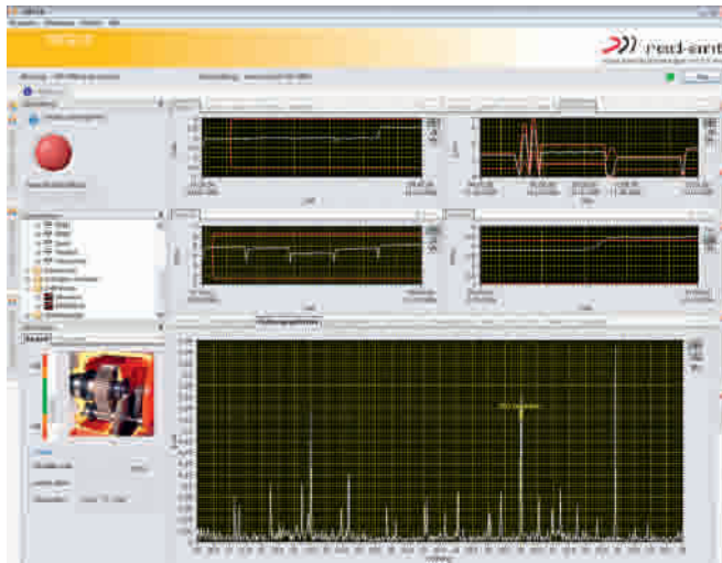
Oberfläche eines SFE-Systems zur Überwachung von Getrieben. Oben: Trend der verschiedenen Bauteile (hier Gangstufen). Unten: hoch auflösendes Ordnungsspektrum mit 128 000 Linien. Bild: red-ant
